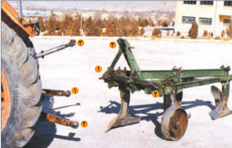
شکل ۲۸-۳- اتصال گاوآهن به تراکتور
