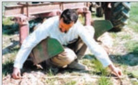
شکل ۳۷-۳- اندازه‌گیری عرض کار گاواهن برگردان دار
