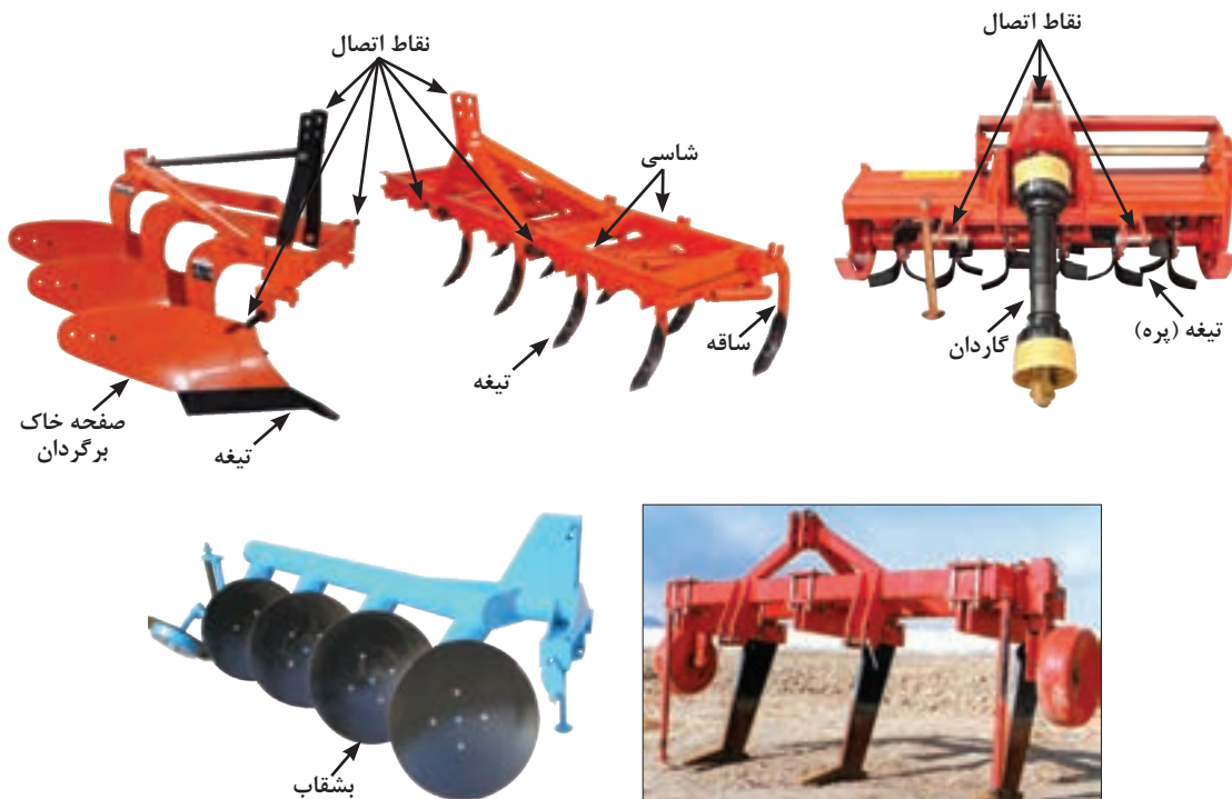
شکل ۱۹-۳- انواع گاوآهن‌ها و نمایش ساختار کلی آن
