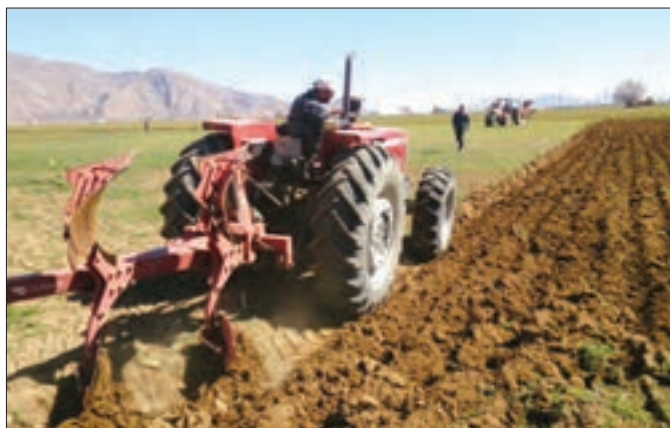
شکل ۳۶-۳- اجرای شخم با گاوآهن برگردان‌دار دوطرفه
