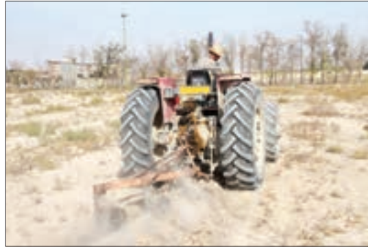
شکل ۲۲-۳ تراکتور بدون اتاق و شخم‌زدن در شرایط نامناسب شکل ۲۳-۳ تراکتور اتاق‌دار و شخم در شرایط مناسب
