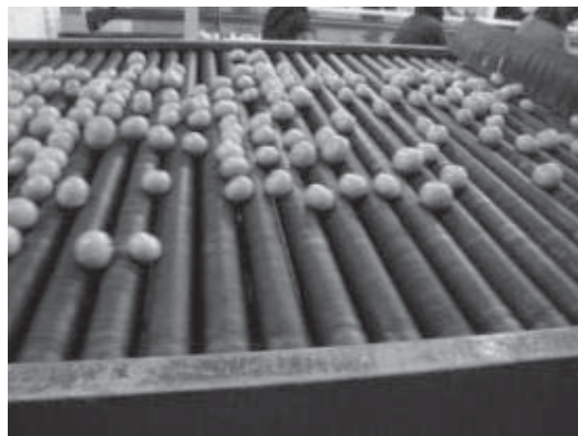
شکل ۷-۴۱- صاف و یکنواخت بودن کف نقاله و عاری بودن از لبه‌های تیز ایجاد کننده زخم
