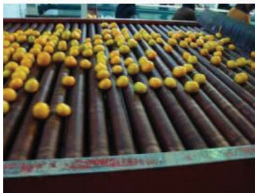
شکل ۷-۴۱- صفحه ۲۴۱: صاف و یکنواخت بودن کف نقاله و عاری بودن از لبه‌های تیز ایجاد کننده زخم
