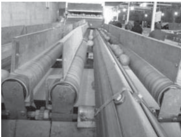
شکل ۷-۴۰- استفاده از لایه‌های ضربه‌گیر روی غلطک‌های درجه‌بندی میوه مرکبات
