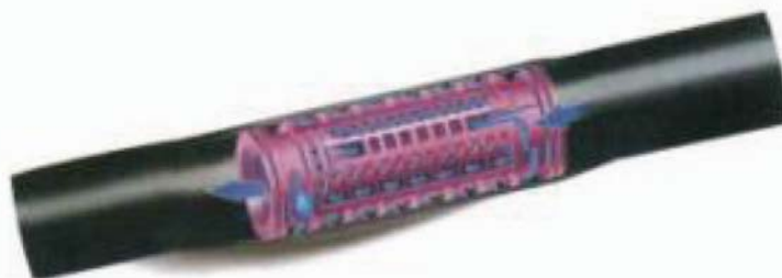
شکل ۳-۵- صفحه ۱۳۰: تصویر شماتیک از مسیر عبور آب در یک نوع قطره چکان
