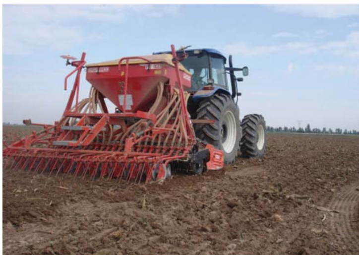
شکل ۷-۶- دستگاه کمبینات: (برای انجام آماده‌سازی بستر کاشت و خرد کردن کلوخه‌ها به‌عنوان یک ماشین مرکب خاک‌ورز - کاشت کاربرد دارد)
