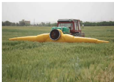
شکل ۶-۱۲- سمپاش بومدار پشت تراکتوری هوا کمک
