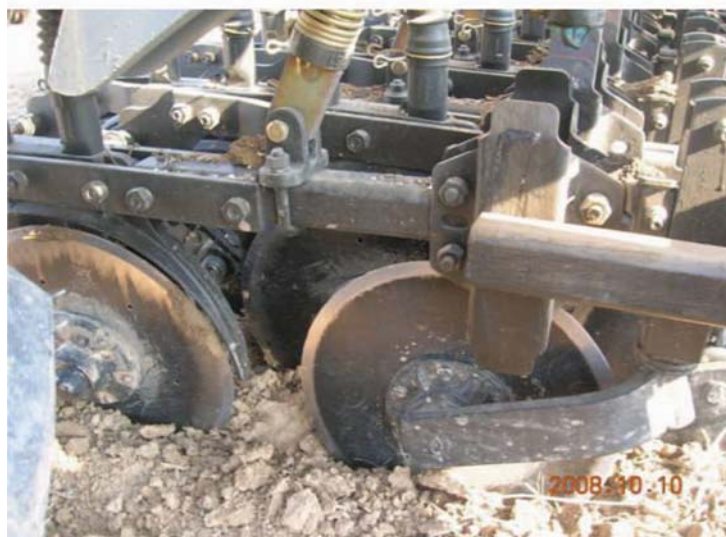
شکل ۷-۳- بذرکار No-Till: (با پیش بر بشقابی صاف و شیار بازکن دو بشقابی) (بذرکار کشت مستقیم در بقایای گیاهی) (پیش برهای بشقابی صاف یا شیار دار که بر روی خاکورزهای مرکب و یا بر ماشینهای کاشت مستقیم در بقایای گیاهی برای برش بقایای کاه و کلش_ ایستاده یا خوابیده_ کاربرد دارند)
