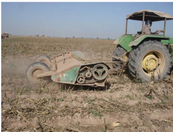
شکل ۷-۵- دستگاه ساقه خردکن: (برای تبدیل بقایای حاصل از کشت ردیفی پیشین در کشتزارهای آبی و آماده‌سازی هرچه بهتر بستر کاشت کاربرد دارد)
