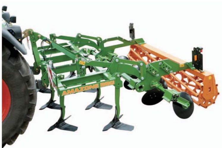
شکل ۷-۱- خاکورز مرکب : (برای انجام ترکیبی عملیات آماده سازی زمین- خاکورزی اولیه و ثانویه- کاربرد دارد)
