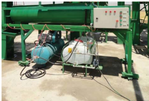
شکل ۹ - ۲۰ - نمایی از یک دستگاه ضدعفونی کننده بذر
