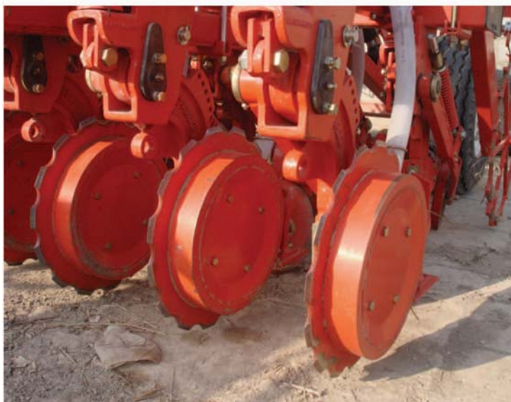
شکل ۷-۴ - بذرکار No-Till: (با شیار بازکن‌های بشقابی کنگره‌دار) (بذرکار کشت مستقیم در بقایای گیاهی) (در انواع بذرکارها برای برش بقایا در سطح گندمزار - ایستاده یا خوابیده - به شکل همراه با عملیات کاشت و یا جدا از کاشت به کار می‌رود)
