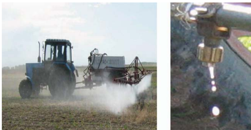
شکل ۵-۴۳- بادبردگی و تلف شدن سم به دلیل ارتفاع نامناسب بوم و نازل‌های نامناسب
