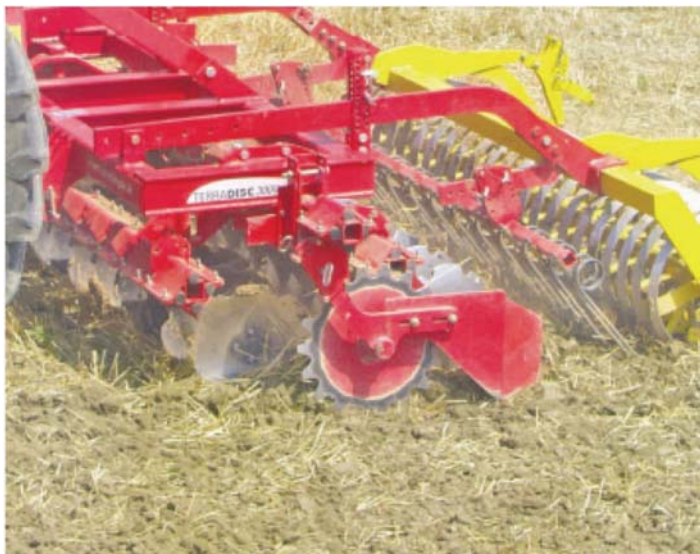
شکل ۷-۷- خاک‌ورز مرکب Terradise: (به منظور آماده‌سازی بستر خاک، خرد کردن کلوخه‌ها و کلش ناشی از کشت پیشین به‌کار می‌رود)
